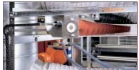
Rodillo extremo para cinta de estiércol con sinfín limpiador
